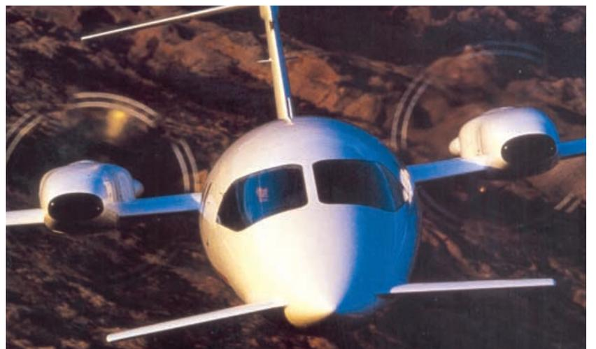
maggiori. Detentore di undici record di velocità nel mondo, l'Avanti avrà nella seconda versione un'autonomia di 1600 miglia nautiche (circa 3000 km.) ad una velocità di 730 km/ora, a quote di crociera di 41.000 piedi (12.500 m). Le nuove performance rendono così il P 180 Avanti II il più moderno e veloce turboprop oggi disponibile sul mercato dei velivoli d'af-
